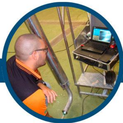
INSPEÇÃO DE SOLDAGEM DE TUBULAÇÃO
