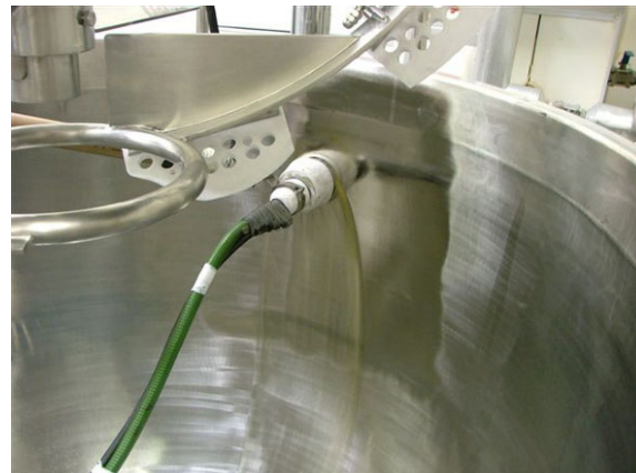
METAL REMOVIDO SELETIVAMENTE DURANTE APLICAÇÃO DA TECNOLOGIA EPL-H PROCESS®
